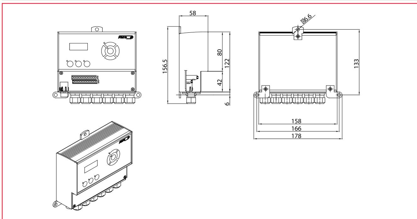
Verdrahtung über Kabelverschraubungen. Schutzklasse IP 65.
