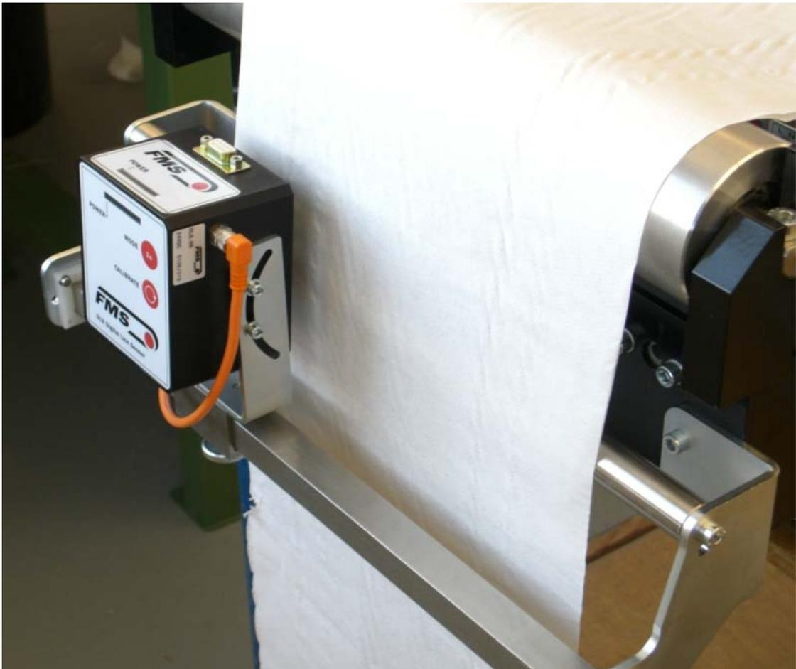
**Bild. 2: Montage des Sensors an der 4-Kant Schiene**
