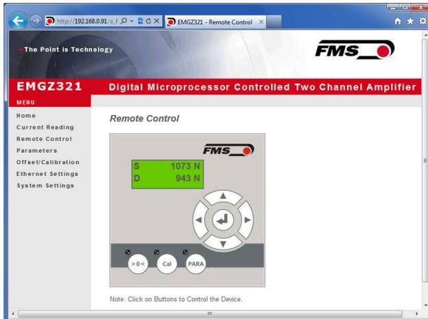
**Bild 25:** Bedienpanel mit Fernsteuerfunktion für den Ethernet-Betrieb
