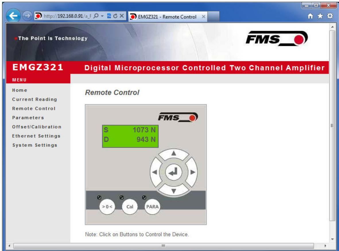
**Bild 31:** Bedienpanel mit Fernsteuerfunktion für den Ethernet-Betrieb Remote Control
