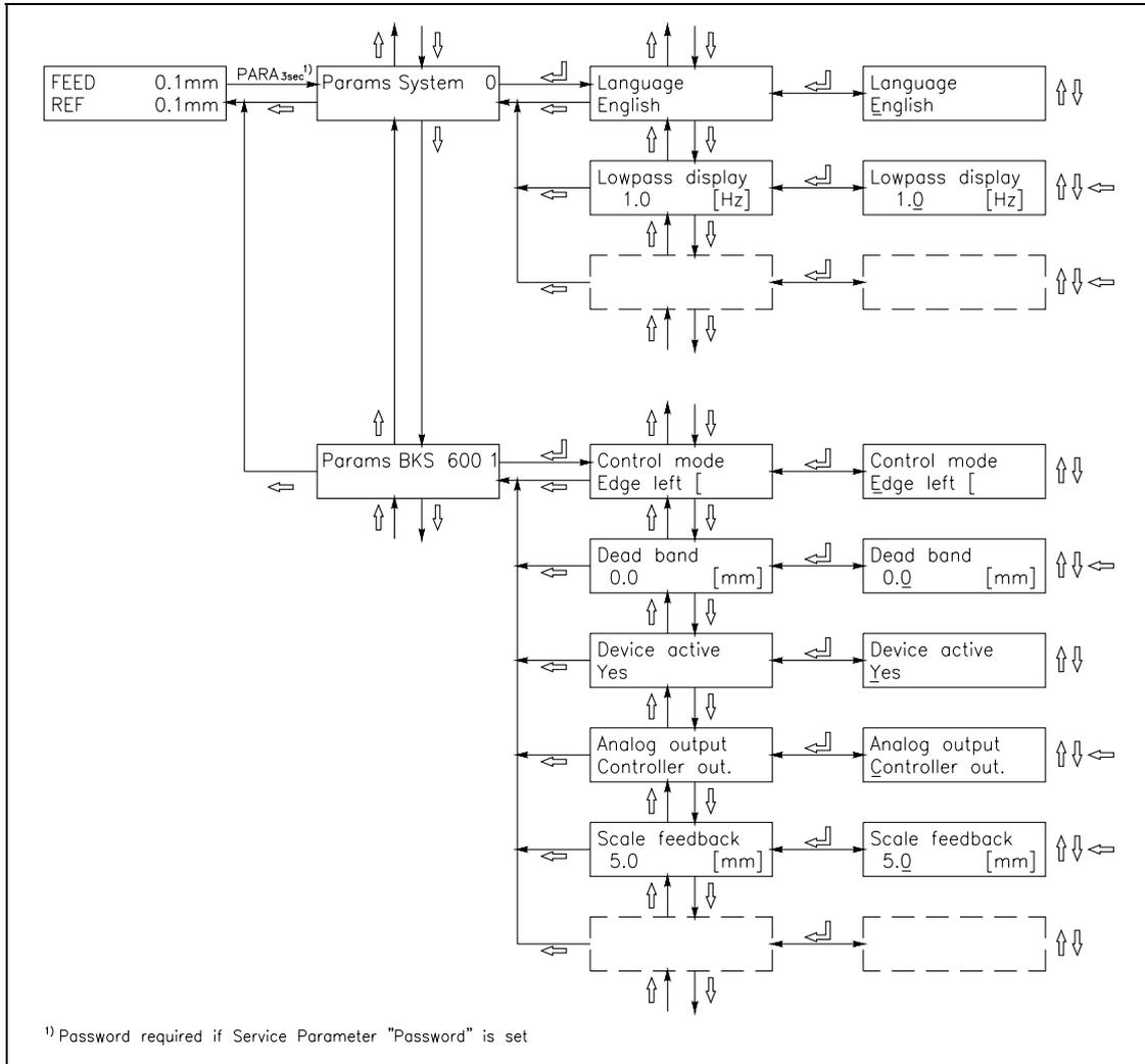
fig. 22: Parametrization BKS600A
