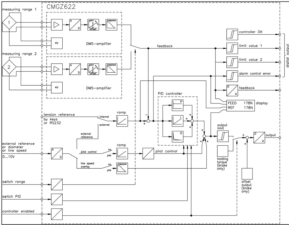
fig. 8: Wiring diagram CMGZ622
