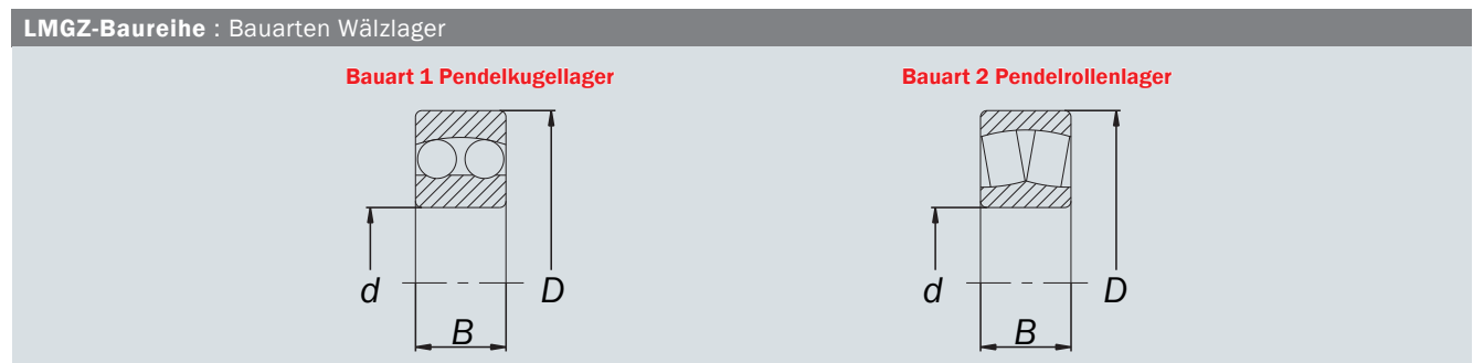
In die Kraftmesslager können unterschiedliche Wälzlager eingebaut werden. Wir empfehlen die Verwendung von Pendelkugel- oder Pendelrollenlagern, damit Winkelfehler ausgeglichen und Messfehler vermieden werden können.
