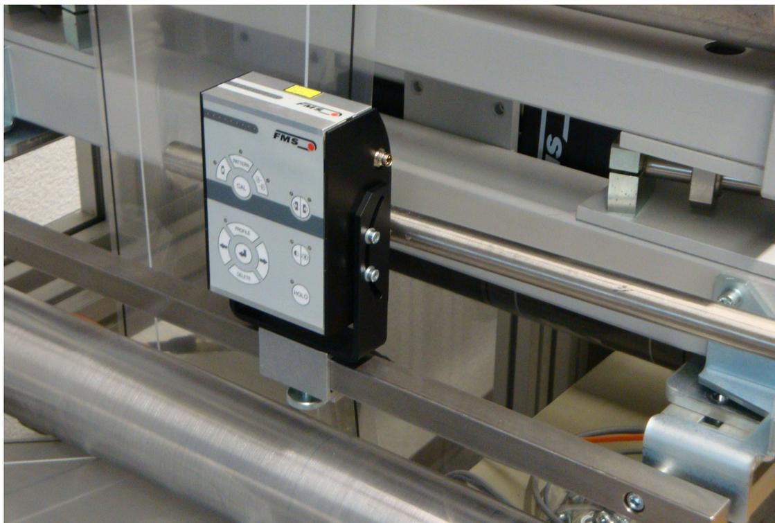
**Bild 2:** Montage des Sensors an der 4-Kant Schiene
