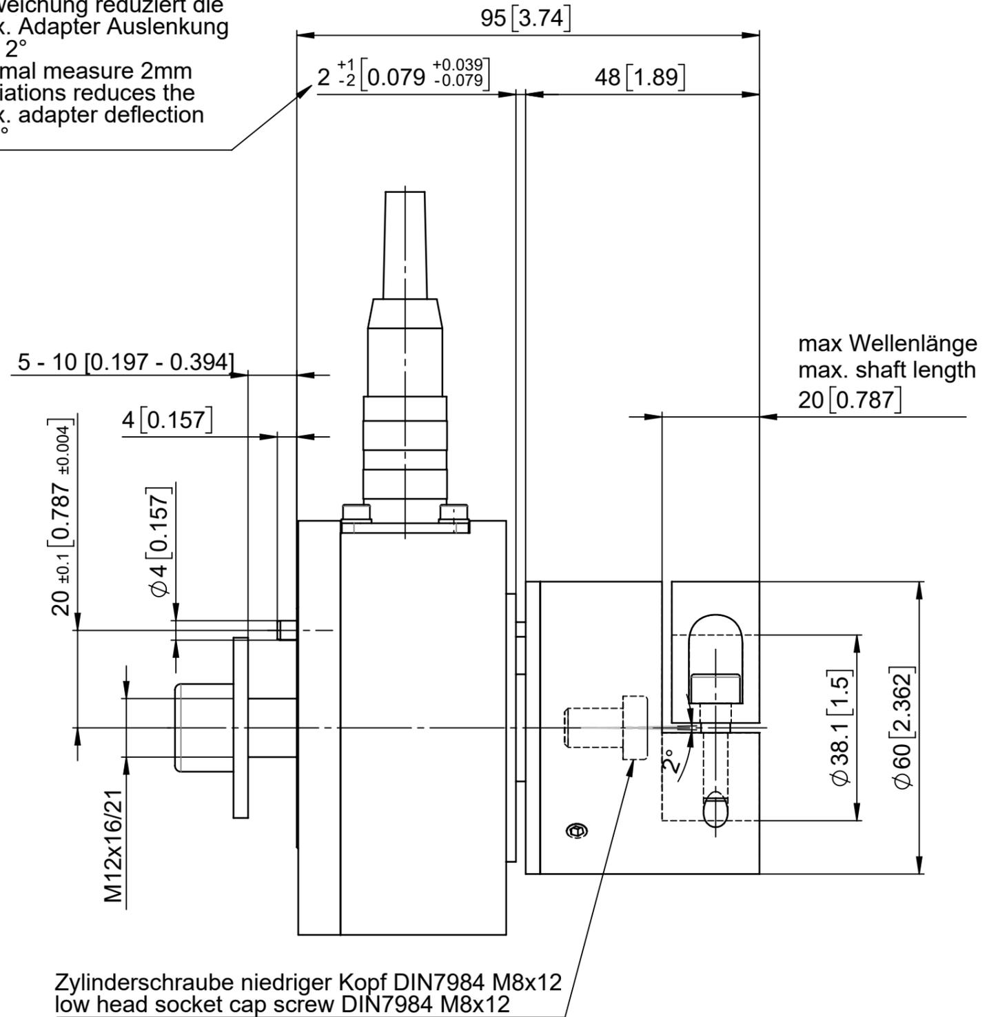
Zylinderschraube niedriger Kopf DIN7984 M8x12
