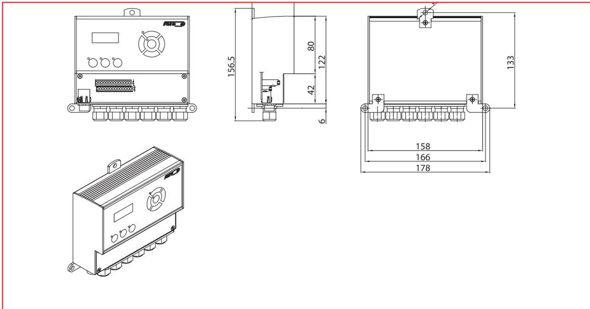
Verdrahtung über PG-Kabelverschraubungen. Schutzklasse IP 65.
