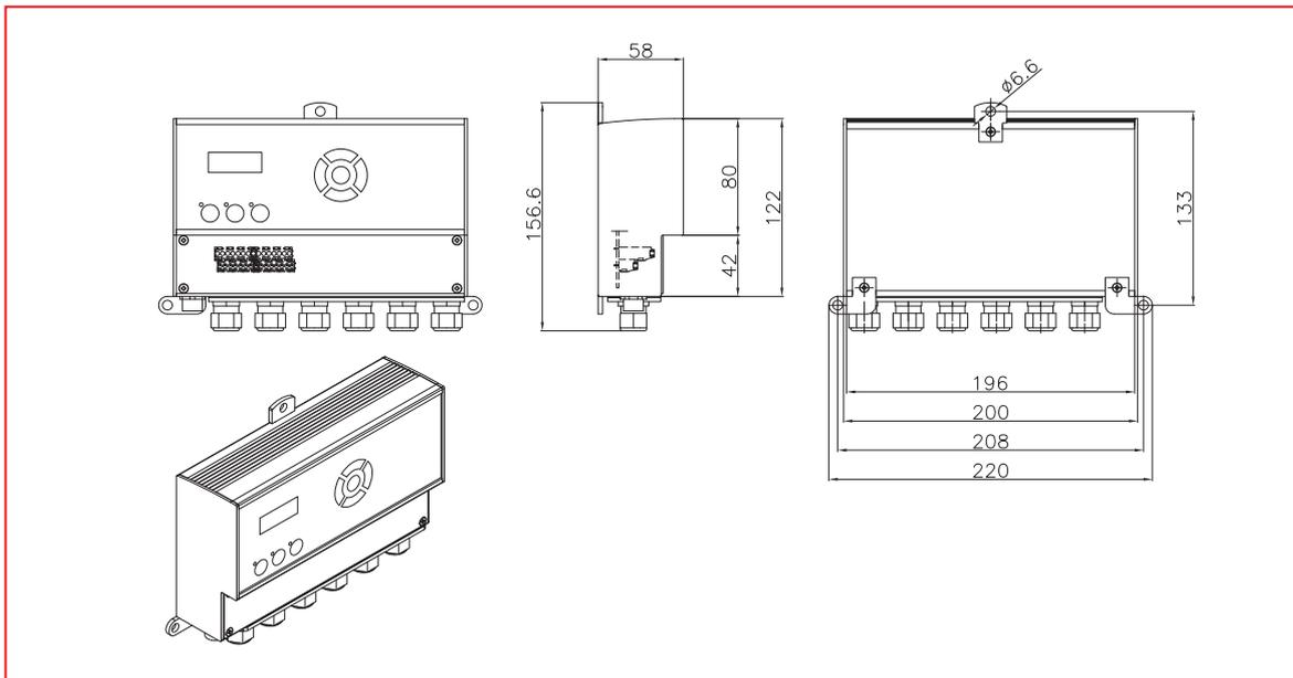
Verdrahtung über PG-Kabelverschraubungen. Schutzklasse IP 65.
