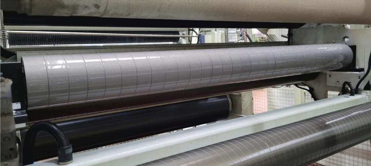
*Abbildung 1: Die FMS-segFORCE verfügt über bis zu 50 unabhängige Kraftaufnehmer, die kleinste Zugabweichungen zwischen den Segmenten messen. Sie ist besonders geeignet für die Verarbeitung von elastischen und empfindlichen Materialien.*
